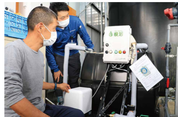
ナノバブル水製造装置を確認する生産者と営農アドバイザー
