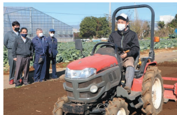
製造したオイルを混合した燃料でトラクターの試運転
