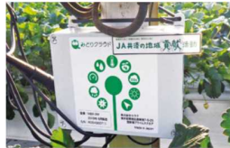
ハウス内環境を可視化する環境モニタリングシステム (伊豆の国地区)
