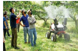
自動無人車による梨への液剤散布 (富士地区)
