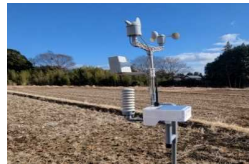
水田の環境を計測する高精度水田センサー (御殿場地区)
